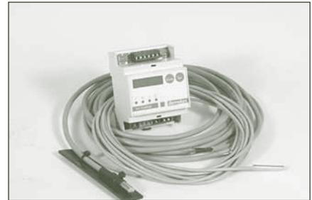
**DHB 350**...Eissteuerung, 230 VAC, 13 A besteht aus einer kombinierten Steuereinheit mit Feuchtigkeits- und Temperatursonde. Die Steuereinheit schaltet das Heizkabel ein, wenn die Umgebungstemperatur unterhalb von 3 Grad Celsius liegt und Eiswasser/Schnee in der Rinne vorliegen.
