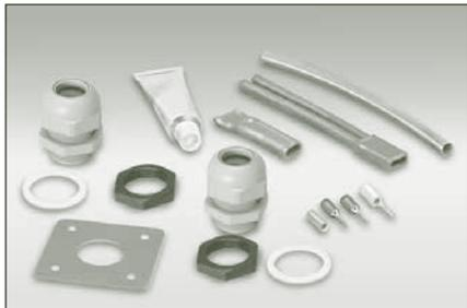
**PETK-SXM-OJ-IND**...Kreisherstellungs-Kit zur Terminierung von SX-Heizkabeln in einer JB-K-1 (oder anderen) Anschlussdose. Set beinhaltet eine M25 Begleitdurchführung (mit Kontermutter), Stromanbindung, Abschlusskappe, RTV-Klebstoff, gelbe/grüne Hülle für Erdungsleitung und die notwendigen Drahtstifte/Ösen, sowie ein Isolierungseingangs-Kit.
